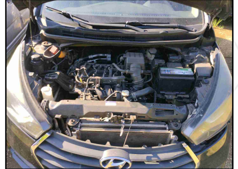
PAINEL CORTA FOGO
