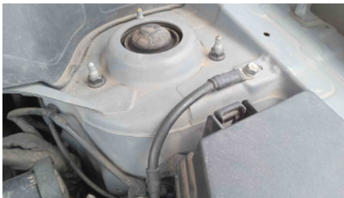
Foto Estrutura Torre do Amortecedor Esquerdo
