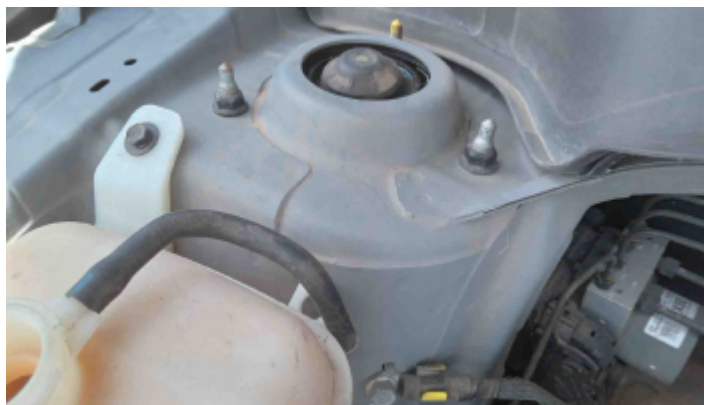
Foto Estrutura Torre do Amortecedor Direito
