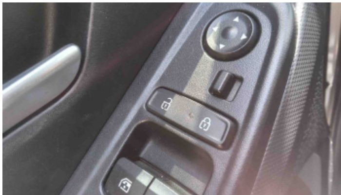
Foto Travas Elétricas
