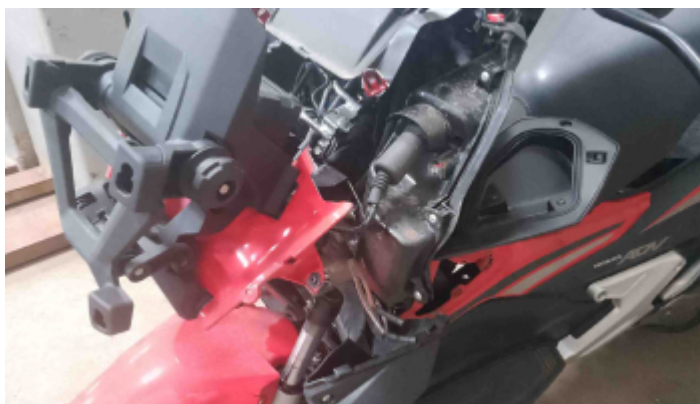
Foto Avaria Carenagem Esquerda
