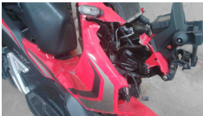
Foto Avaria Carenagem Direita
