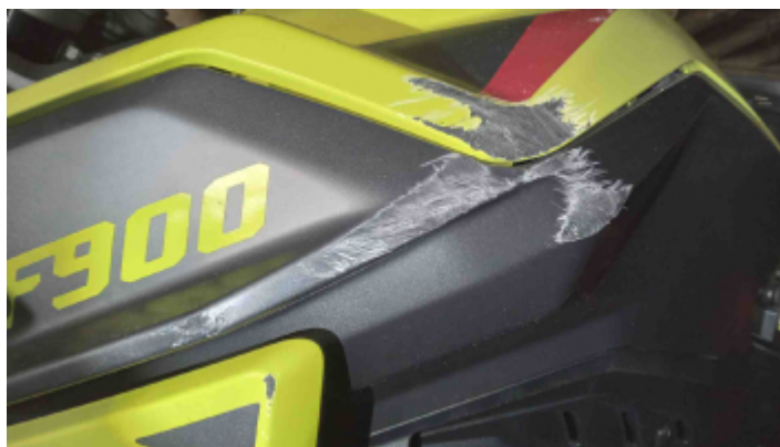
Foto Avaria Carenagem Esquerda
