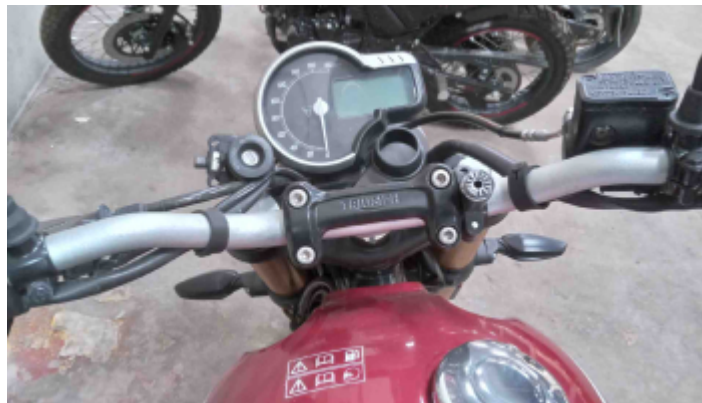
Foto Estrutura Mesa
