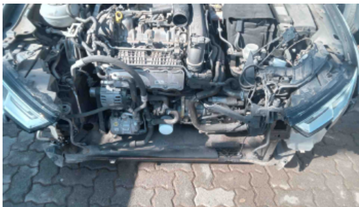
Foto Avaria Painel/Saia Dianteiro
