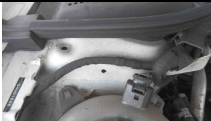
Foto Estrutura Torre do Amortecedor Direito
