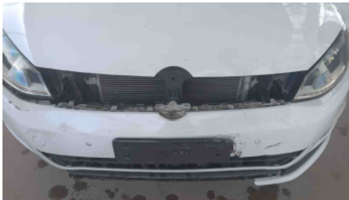
Foto Avaria Grade
