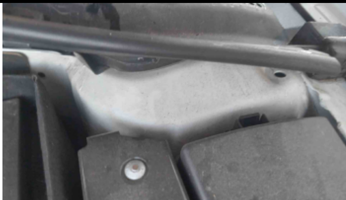
Foto Estrutura Torre do Amortecedor Esquerdo
