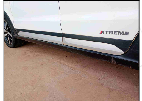
CAIXAS DE AR - SOLEIRA ESQUERDA
