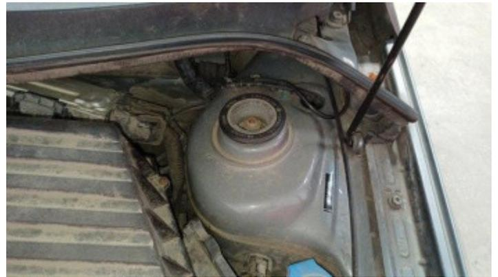
Estrutura Torre do Amortecedor Esquerdo
