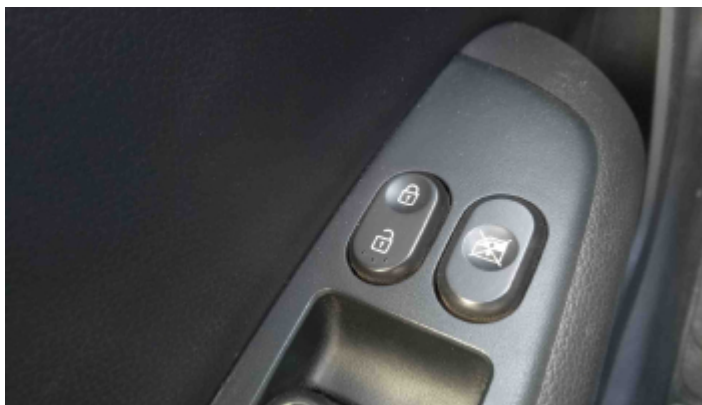
Foto Travas Elétricas
