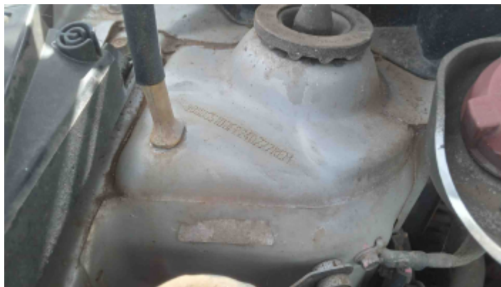
Foto Estrutura Torre do Amortecedor Direito
