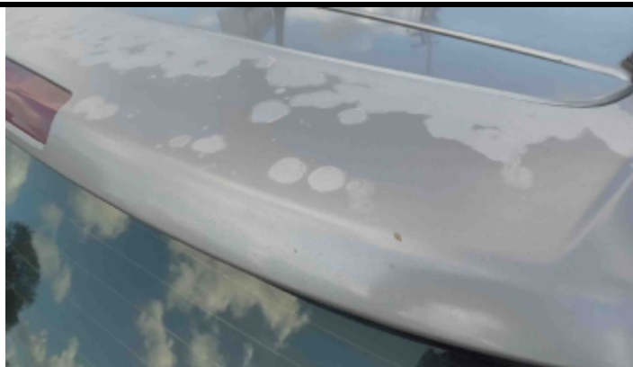
Foto Avaria Tampa do Porta Malas
