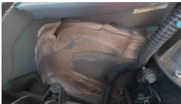
Foto Estrutura Torre do Amortecedor Direito
