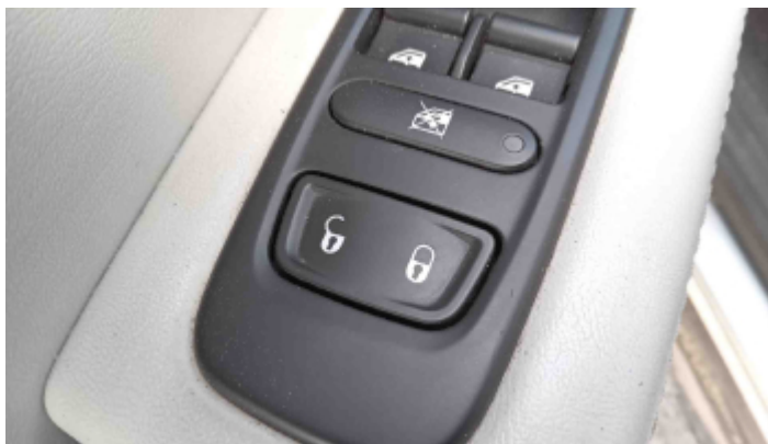
Foto Travas Elétricas
