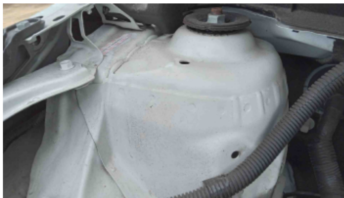
Foto Estrutura Torre do Amortecedor Direito
