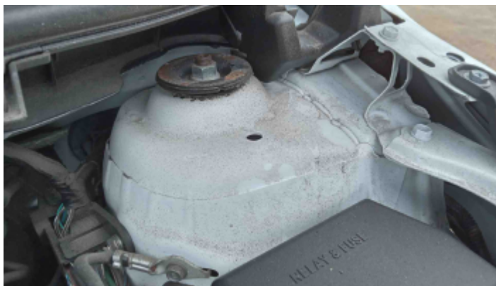
Foto Estrutura Torre do Amortecedor Esquerdo
