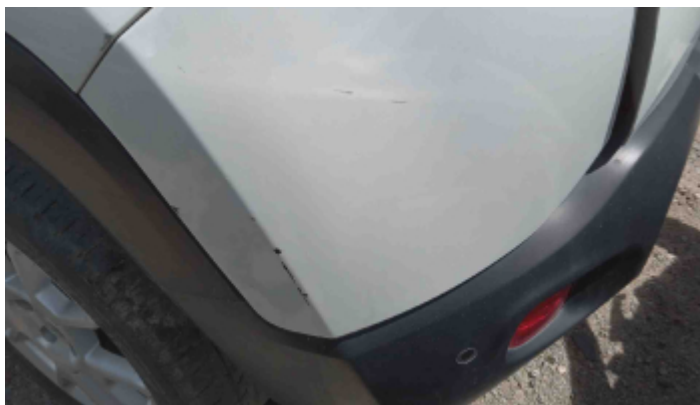
Foto Avaria Pára-Choque Traseiro
