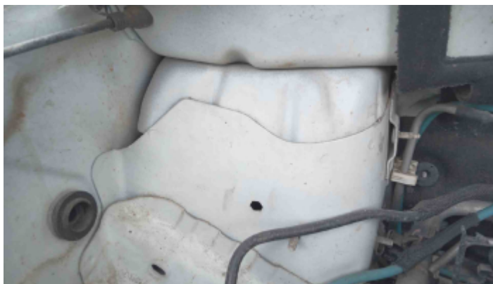
Foto Estrutura Torre do Amortecedor Direito
