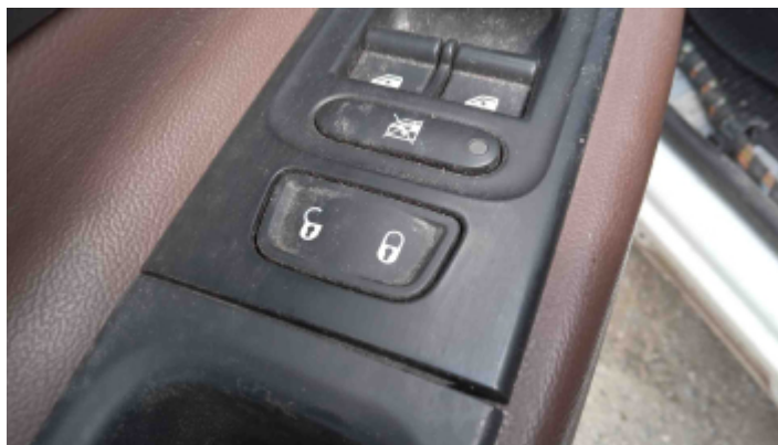
Foto Travas Elétricas
