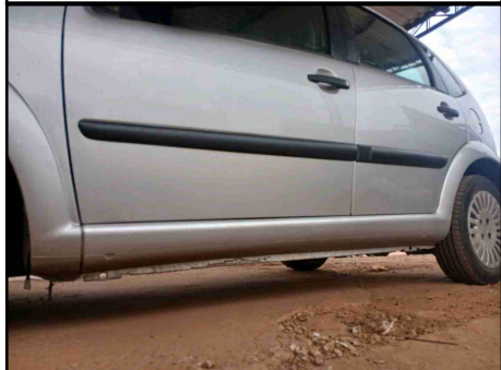
CAIXAS DE AR - SOLEIRA ESQUERDA
