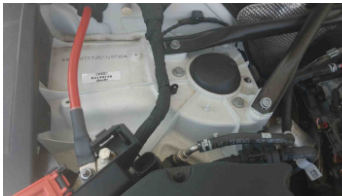
Foto Estrutura Torre do Amortecedor Esquerdo
