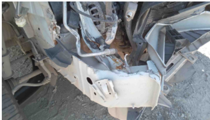
Foto Estrutura Longarina Direita
