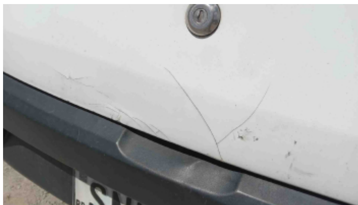
Foto Avaria Tampa do Porta Malas
