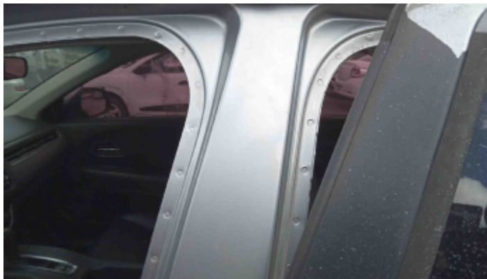
Foto Estrutura Coluna Central Esquerda
