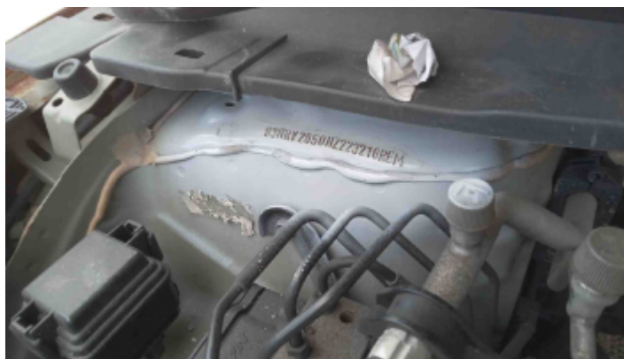
Foto Estrutura Torre do Amortecedor Direito
