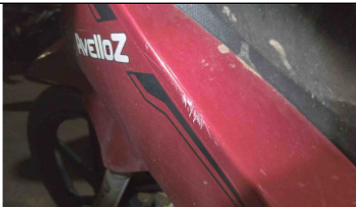
Foto Avaria Carenagem Esquerda
