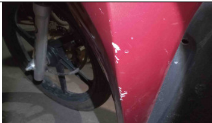
Foto Avaria Carenagem Esquerda
