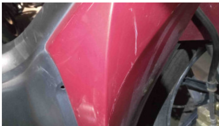
Foto Avaria Carenagem Direita
