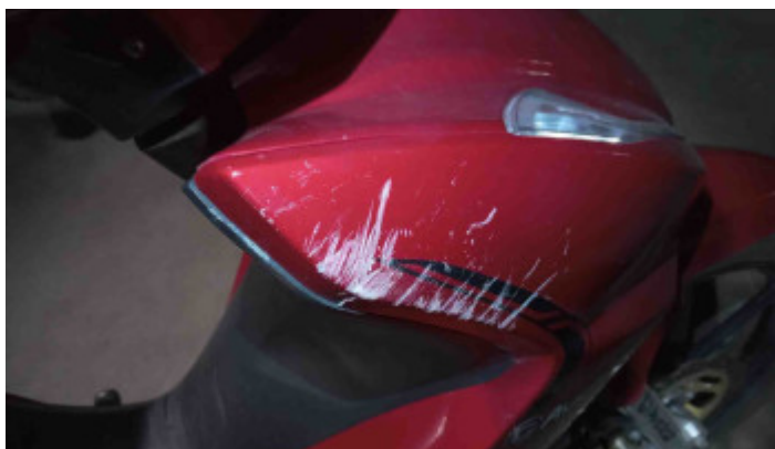
Foto Avaria Carenagem Direita
