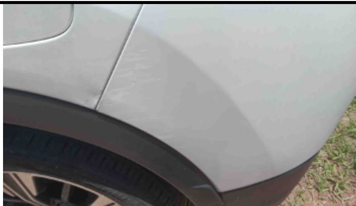
Foto Avaria Pára-Choque Traseiro
