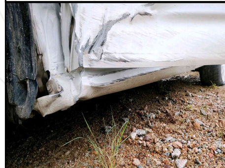
CAIXA DE AR/ SOLEIRA ESQUERDA
