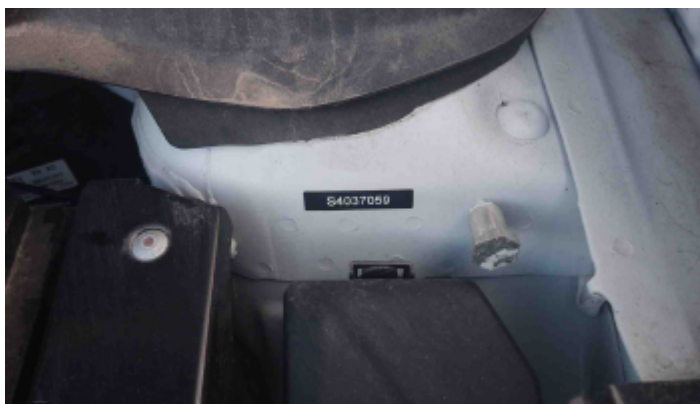
Foto Estrutura Torre do Amortecedor Esquerdo
