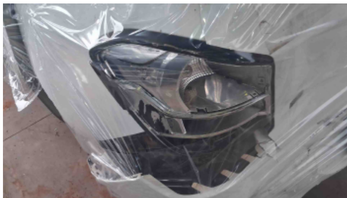
Foto Avaria Lanterna Esquerda
