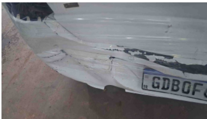
Foto Avaria Pára-Choque Traseiro
