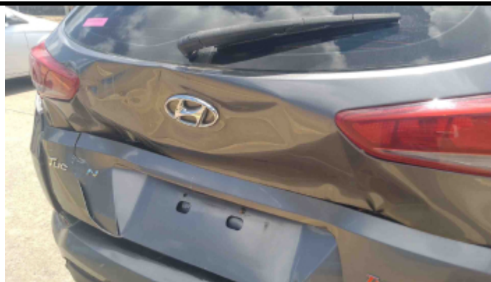
Foto Avaria Tampa do Porta Malas
