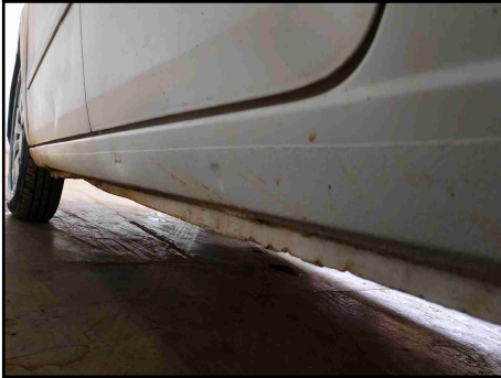
CAIXA DE AR/ SOLEIRA ESQUERDA
