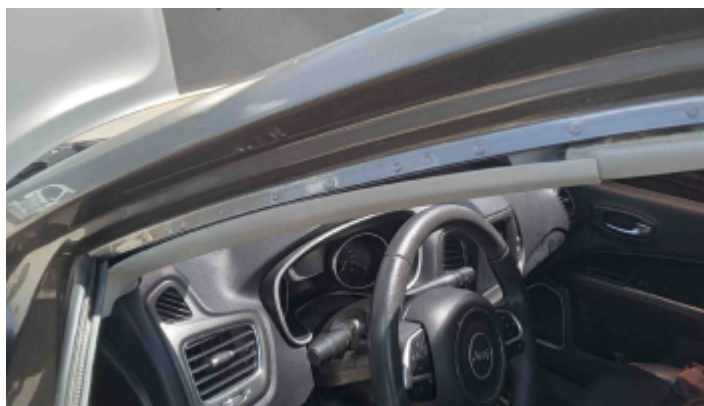
Foto Estrutura Coluna Dianteira Esquerda
