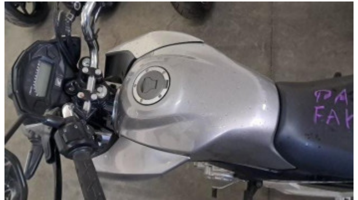
TANQUE DE COMBUSTIVEL
