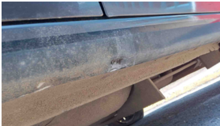
Foto Avaria Caixa de Ar (lado esquerdo)
