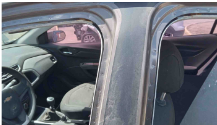
Foto Estrutura Coluna Central Esquerda
