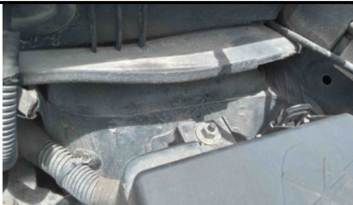
Foto Estrutura Torre do Amortecedor Esquerdo
