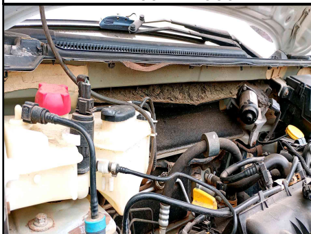
PAINEL CORTA FOGO
