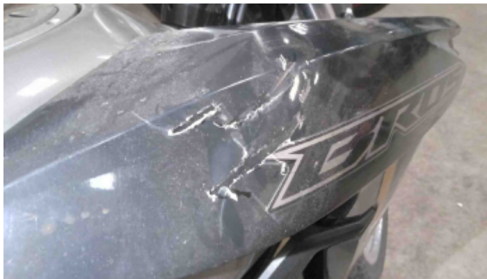
Foto Avaria Carenagem Direita
