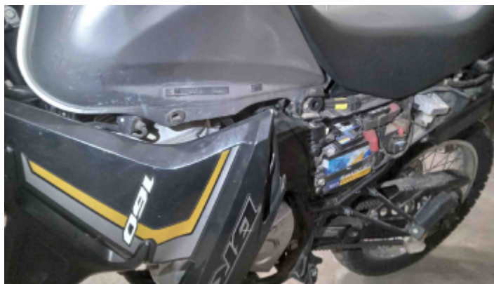
Foto Avaria Carenagem Esquerda
