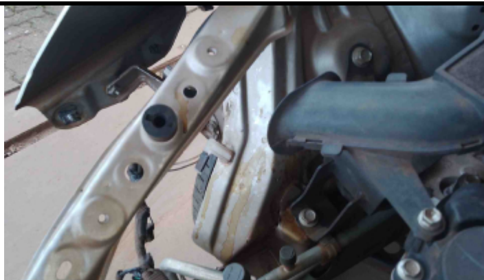
Foto Estrutura Torre do Amortecedor Direito
