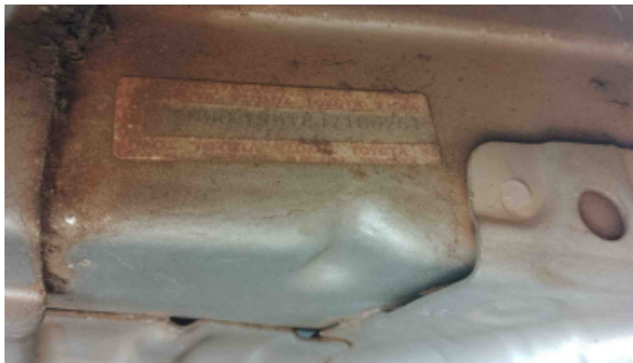
Foto da etiqueta ETA (compartimento do motor)
