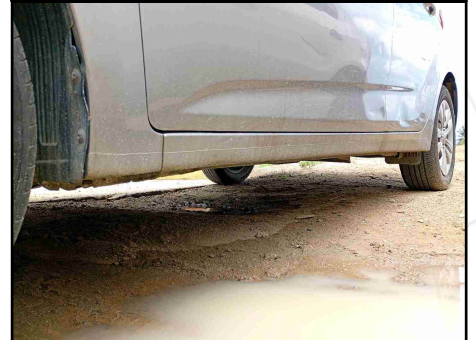
CAIXAS DE AR - SOLEIRA ESQUERDA
