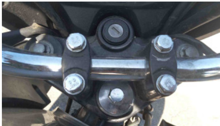
Foto Estrutura Mesa
