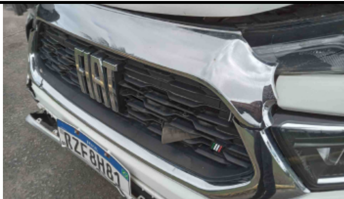
Foto Avaria Grade
