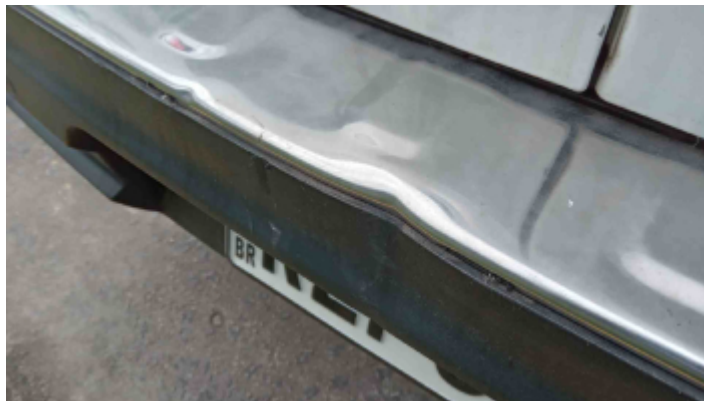
Foto Avaria Pára-Choque Traseiro
