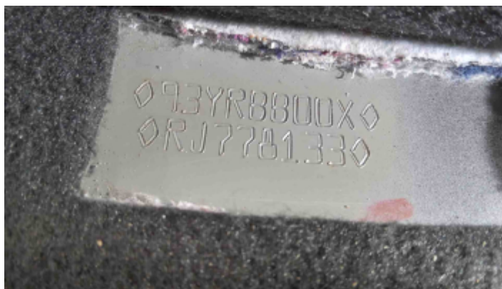
Foto da etiqueta ETA (assoalho)
