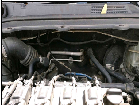
PAINEL CORTA FOGO
