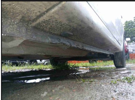
CAIXAS DE AR - SOLEIRA ESQUERDA
