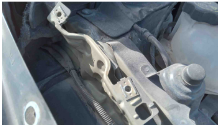
Foto Avaria Painel Dianteiro
