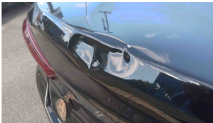
Foto Avaria Tampa do Porta Malas
