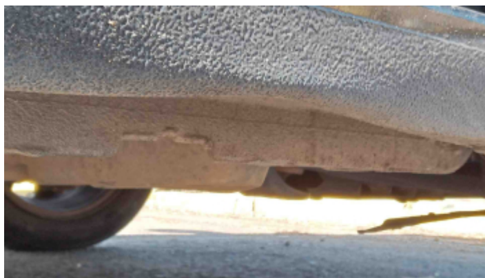
Foto Avaria Caixa de Ar (lado direito)
