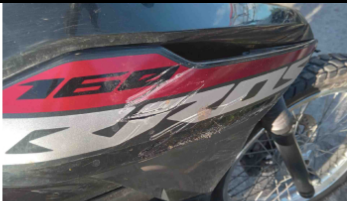
Foto Avaria Carenagem Direita
