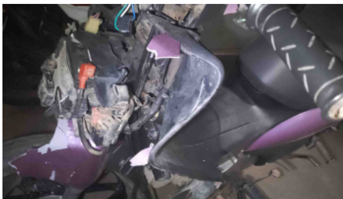
Foto Avaria Carenagem Esquerda
