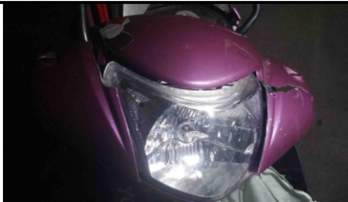
Foto Avaria Carenagem Frontal
