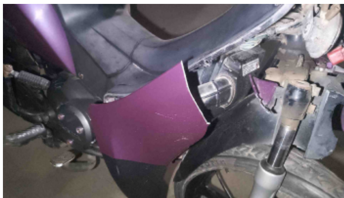
Foto Avaria Carenagem Direita
