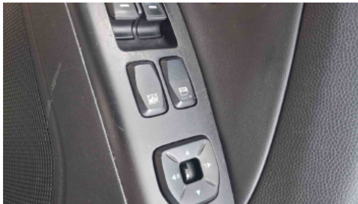
Foto Travas Elétricas
