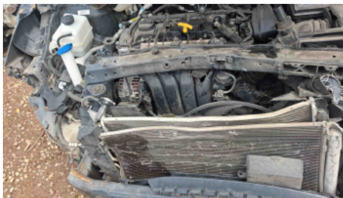
Foto Avaria Painel/Saia Dianteiro
