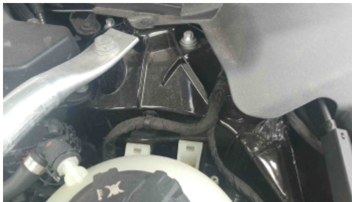
Foto Estrutura Torre do Amortecedor Esquerdo
