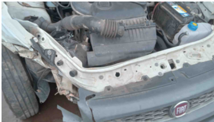
Foto Avaria Painel/Saia Dianteiro
