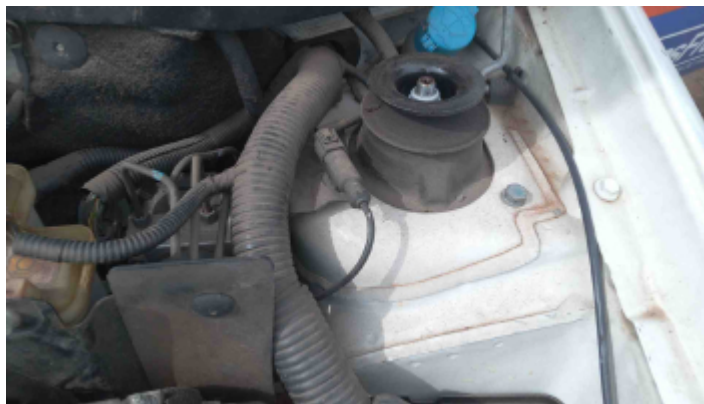
Foto Estrutura Torre do Amortecedor Esquerdo
