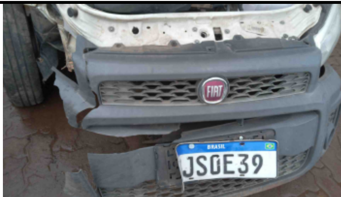
Foto Avaria Grade
