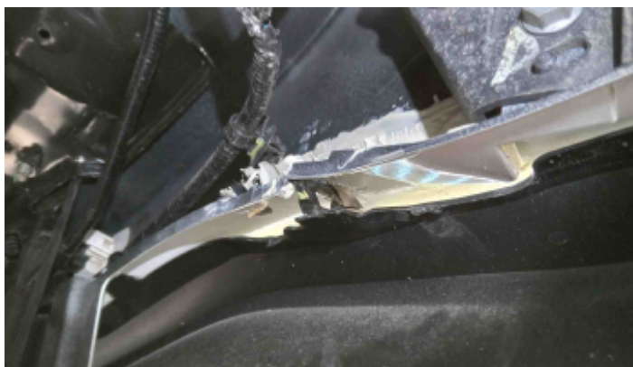
Foto Avaria Pára-Choque Traseiro
