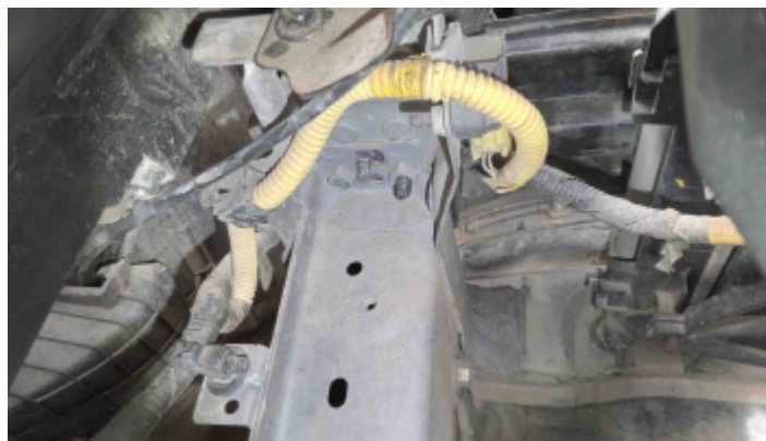
Foto Estrutura Longarina Esquerda
