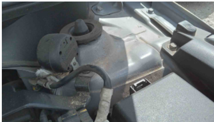
Foto Estrutura Torre do Amortecedor Esquerdo
