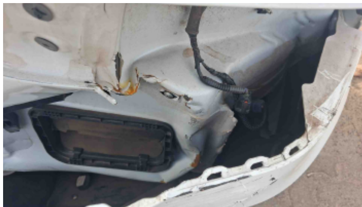
Foto Avaria Painel/Saia Traseiro
