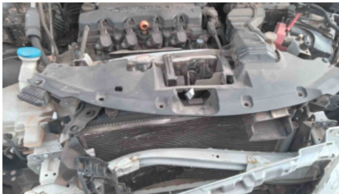
Foto Avaria Painel/Saia Dianteiro
