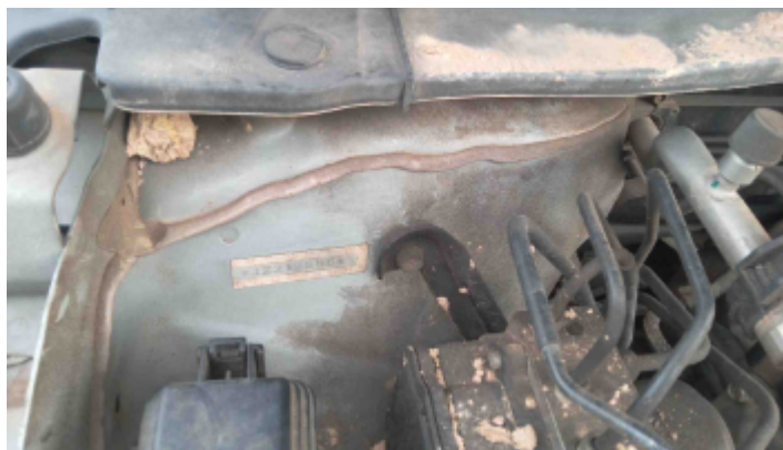
Foto Estrutura Torre do Amortecedor Direito
