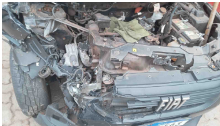
Foto Avaria Painel/Saia Dianteiro
