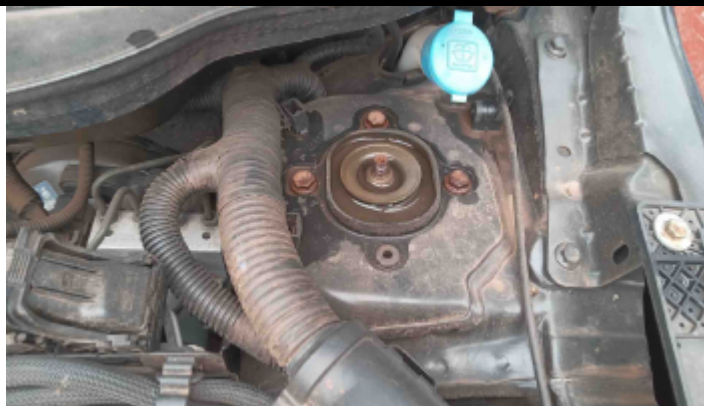
Foto Estrutura Torre do Amortecedor Esquerdo
