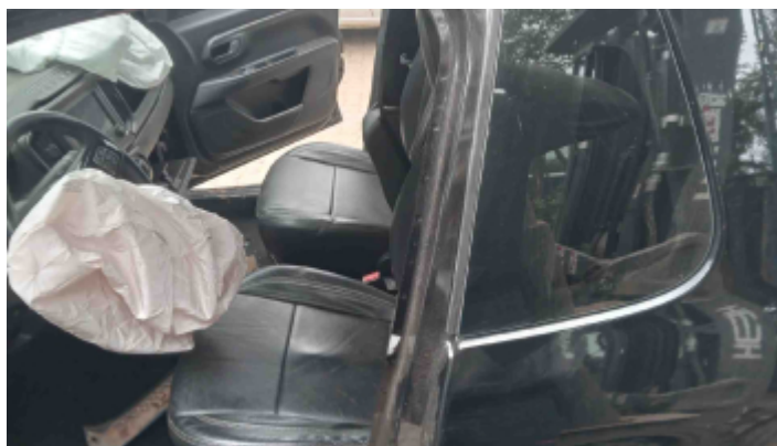
Foto Estrutura Coluna Central Esquerda
