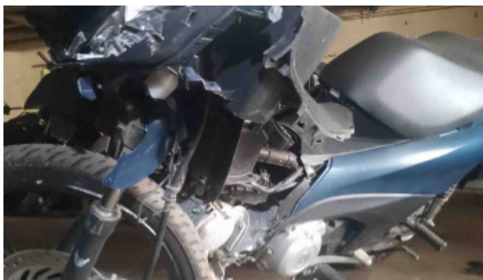
Foto Avaria Carenagem Esquerda
