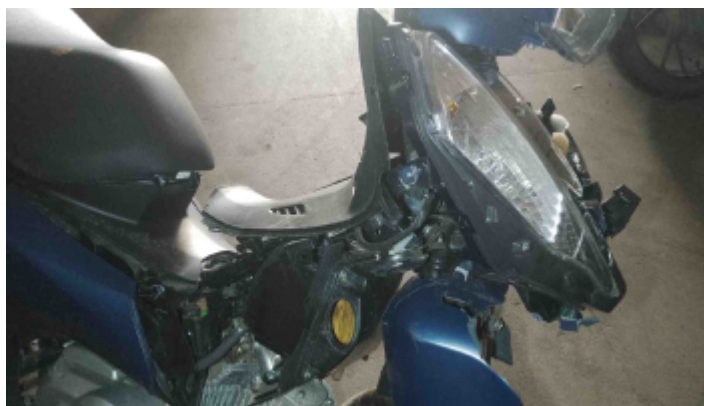
Foto Avaria Carenagem Direita
