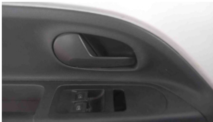
Foto Travas Elétricas
