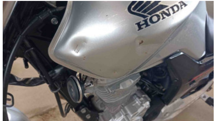
Foto Avaria Tanque
